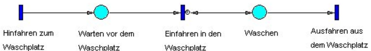
Abb. 2.7: Die Waschstraße unter Verwendung eines Inhibitors
